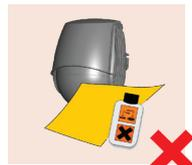
Für die Reinigung der optischen Bauteile keine aggressiven Produkte oder trockenen Handtücher verwenden.
