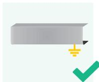
Der Metallsockel auf dem der Sensor montiert wird, muss ordnungsgemäß geerdet werden.
